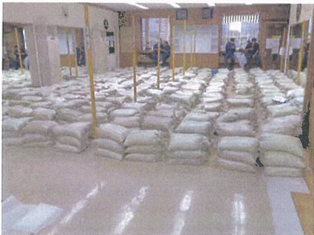
ถุงทรายที่ใช้เป็นน้ำหนักบรรทุกทดสอบ บนพื้นที่ทดสอบ
