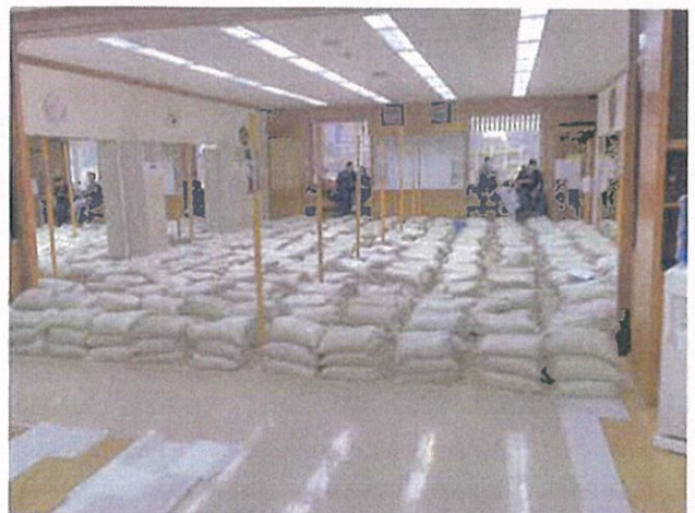
ถุงทรายที่ใช้เป็นน้ำหนักบรรทุกทดสอบ บนพื้นที่ทดสอบ
