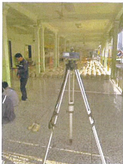
กล้องระดับความละเอียดสูงที่ใช้ตรวจวัดการแอ่นตัวของพื้น
